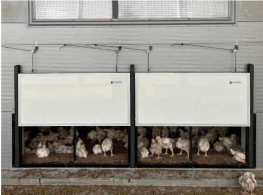
Für einen besonders hohen Isolationswert fertigen wir eine Auslaufschieber mit einem Schieber aus 32 mm dickem PS-Sandwichpaneel. Um diese Auslaufschieber herum befindet sich ein Aluminiumprofil, in dem eine Gummidichtung für eine zugfreie Abdichtung montiert ist.
