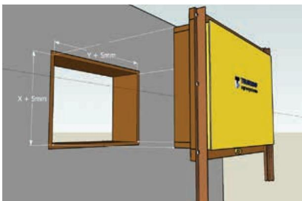
Der Flash BP ist aus hochwertigem Betonplex und ist in jeder Größe erhältlich. Für den Einbau rechnen Sie mit einer zusätzlichen Aussparung von 5 mm.
