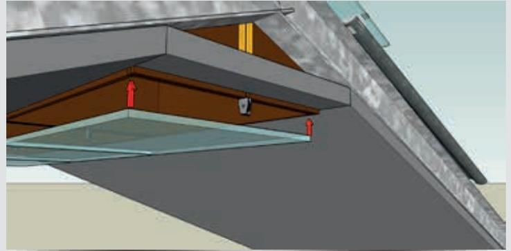
8. Die untere Polykarbonatplatte anbringen und mit 4 Schrauben befestigen.
