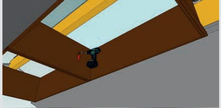
2. Kitt zwischen den Elementen anbringen und diese dann mithilfe von 30-mm-Schrauben miteinander verbinden.
