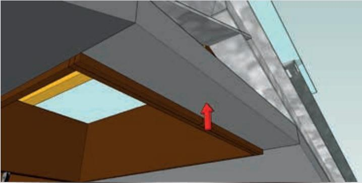
7. Beim Sparren bleibt eine recht große Öffnung zwischen den Elementen. Diese mit Isoliermaterial füllen.
