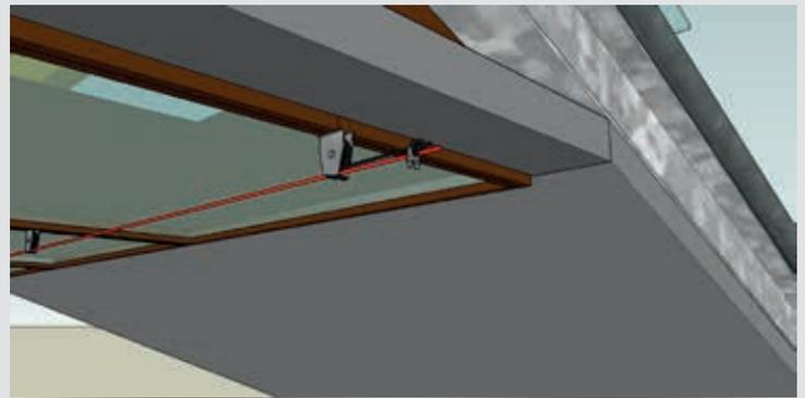
10. Den Zugdraht anbringen und die Lamellenschnur mit Drahtseilklemmen mit dem Zugdraht verbinden.
