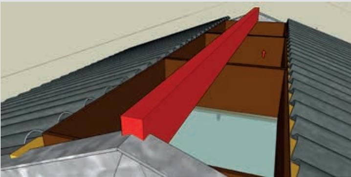
3. Firstbalken auf den Elementen montieren. Dabei auf die korrekte Höhe des Balkens achten, damit die Dachneigung gleichmäßig ist. Dies muss bei der Arbeit gemessen werden.
