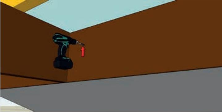
1. Elemente mithilfe eines Scherenhubtischs von unten anbringen: von innen an den Dachpfetten festschrauben. Mindestens 6 Schrauben je Element verwenden.
